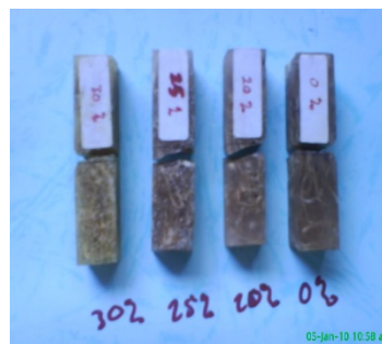
Gambar 8. Bentuk patahan setelah diuji Impact
