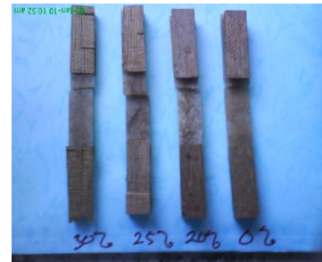
Gambar 6. Bentuk patahan setelah diuji tarik
